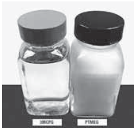
室温で固体のPTMEG（右）に比べ液体の3MCPGは最終製品の低温特性も高められる
